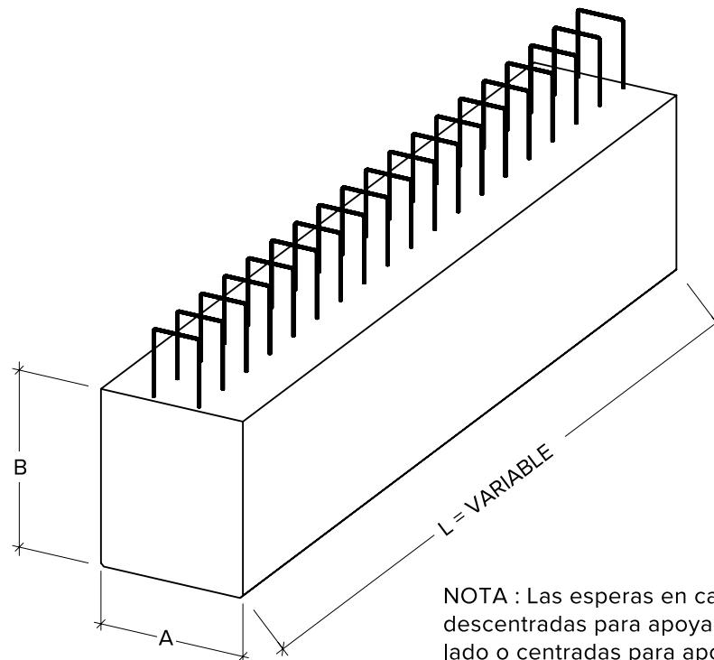
NOTA : Las esperas en cabeza pueden ser descentradas para apoyar placa alveolar por un lado o centradas para apoyar placa por ambos lados.
